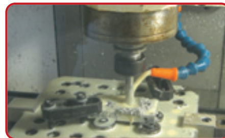
Ici on voit en direct l'usinage du bâti moteur sur une machine à commande numérique.
