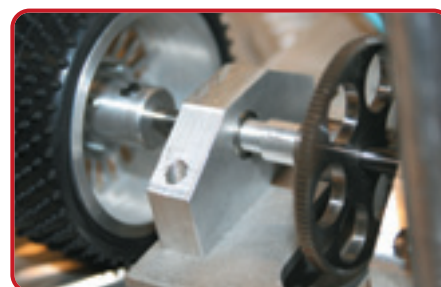
Fixe de transmission en carbure, palier alu, roulements, couronne acier, de la belle ouvrage.
