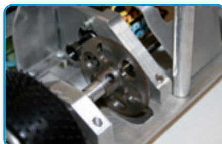
Les pignons proviennent du commerce, mais les couronnes acier sont fabriquées par une société spécialisée.
