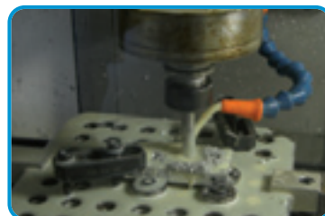
Usinage d'un polier moteur. L'outil et la pièce sont lubrifiés en permanence.
