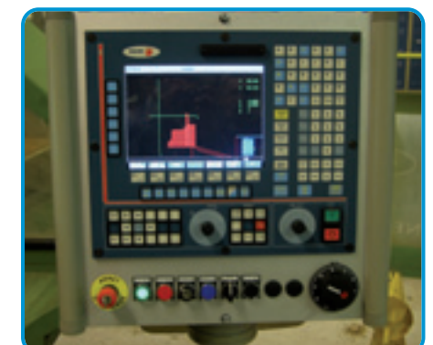
L'écran matérialise un plan de coupe de la pièce à réaliser. En rouge les parties que doit ôter la machine.
