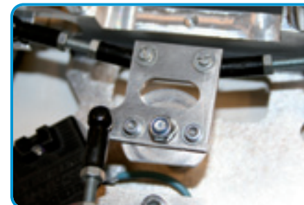
Le système de direction se veut ultra simple. Le positionnement des biellettes induit un effet Ackermann assez étrange, mais cela n'a aucune importance ici.
