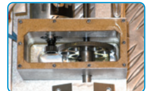
Une équipe a réalisé ce carter étanche permettant une lubrification permanente de la couronne par barbotage ! Je ne suis pas sûr de l'intérêt, compte tenu du surplus de poids, mais l'intérêt réside dans l'idée et la réalisation.
