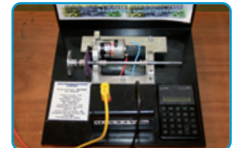
Le banc moteur pour tester le Speed 550 sur la durée. Le moteur que l'on voit ici a tourné près de 48 heures sur le banc !
